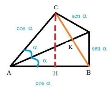
Nel triangolo rettangolo AHC :  $AC = \cos \alpha$  ,  $AH = \cos \alpha \cdot \cos 2 \alpha$  e  $CH = \cos \alpha \cdot \sin 2 \alpha$ . Nel triangolo ABC possiamo calcolare l'area in due modi
