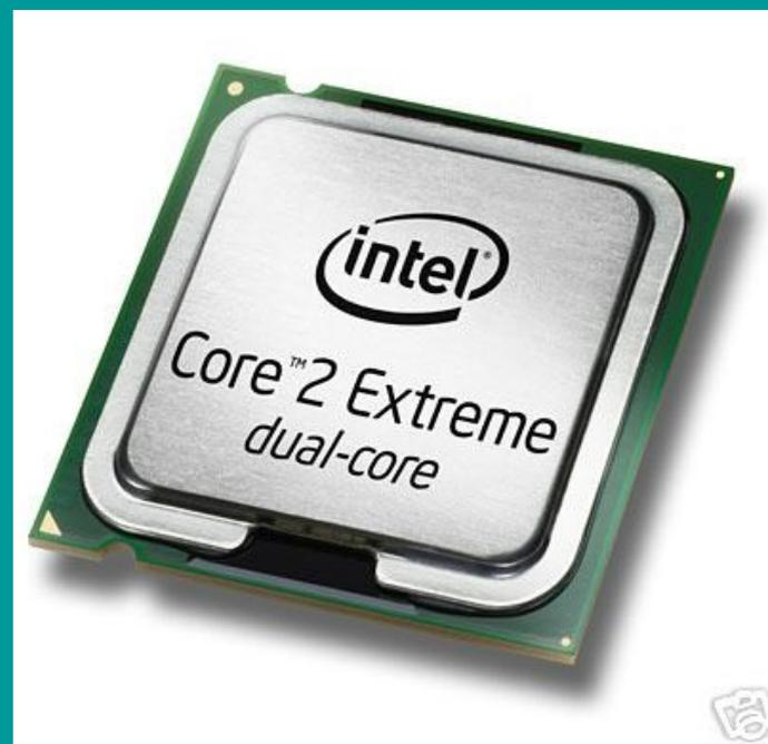
L'**unità centrale di elaborazione**, in sigla **CPU** (dal corrispondente termine inglese *central processing unit*), anche chiamata nella sua implementazione fisica **processore**, è uno dei due componenti principali del computer.
