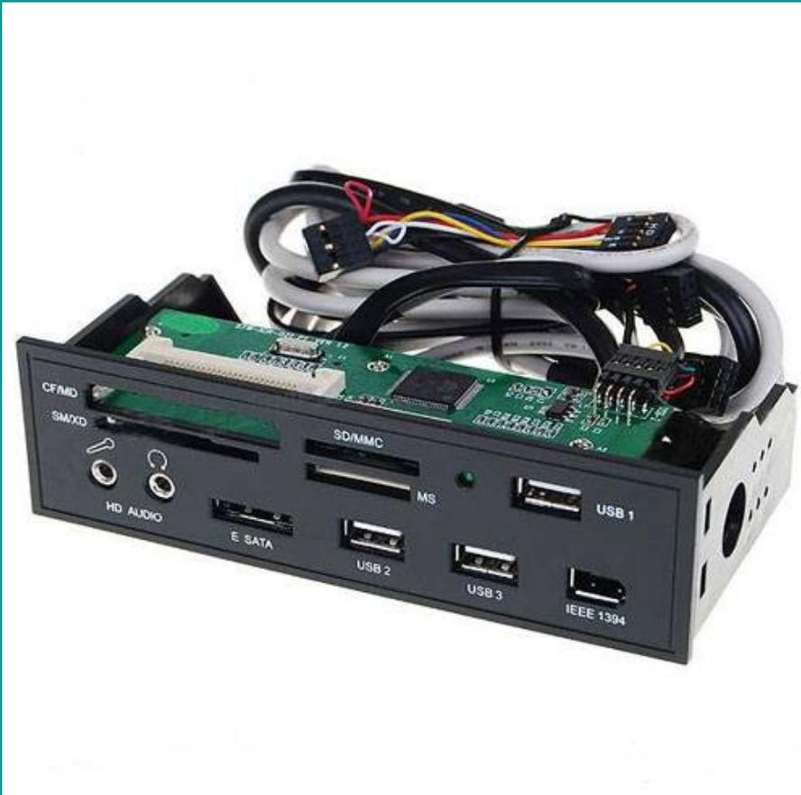
Una scheda **memory card reader & writer** è un componente del computer che permette la lettura e la scrittura dei vari tipi di memory card.
