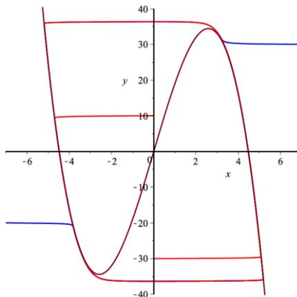
È doveroso precisare che quest'analisi vuol essere soltanto teorica; anzitutto si noti, dal grafico in alto a sinistra, che la tensione sul condensatore – pur partendo da un valore modesto e in assenza di corrente – è rapidamente soggetta a oscillazioni assai ampie: l'ingente quantità di energia necessaria a sostenerle dovrebbe quindi essere fornita dall'apparato che pilota la valvola...
